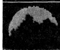
Abb. 4. \text{Li}^+ -Ionenbild eines anderen Objekts. Einstufige ionenoptische Vergrößerung durch Ausschaltung des Projektivs. Gleiche lichtoptische Vergrößerung wie in Abb. 3b.
